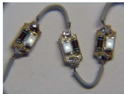
In serie bedraad ledcircuit, zoals dat in praktijk veel voorkomt. Houd er rekening mee dat er slechts één draad tussen de modules zit, zoals in kerstboomverlichting.
